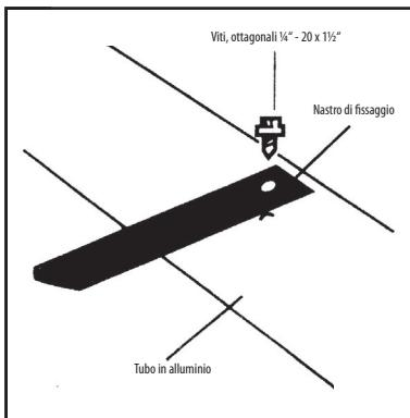
Creare perforazioni nel tubo in alluminio con l'ausilio di un trapano, adatte al fissaggio dei nastri della copertura a bolle a norma Iso
