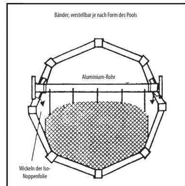
Antes de enrollarla centrar la lámina de plástico de burbujas isotérmica y enrollar una primera vuelta manualmente
