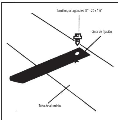
Taladre orificios en los tubos de aluminio, apropiados para la fijación de las cintas de la lámina de plástico de burbujas isotérmica
