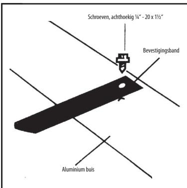
Boor gaten in de aluminium bui(en), passend voor het bevestigen van de banden van het noppenzeil
