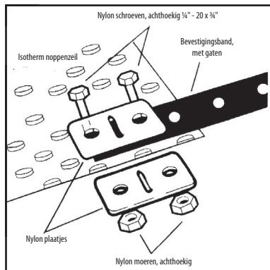
Let er bij het bevestigen van de riemen op dat deze op gelijke afstand van elkaar komen. De lengte van de bevestigingsbanden moet worden aangepast aan de vorm van de pool.
