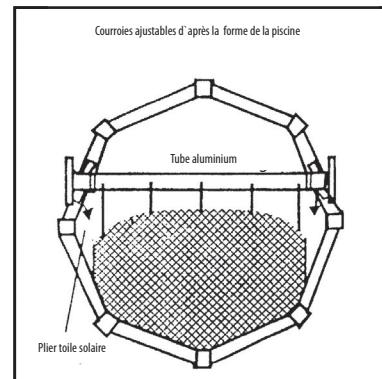
Lorsque vous installez le courroies à la toile solaire, elles doivent être à égale distance entre elles. La longueur des courroies doit être ajustée en fonction de la form de piscine.
