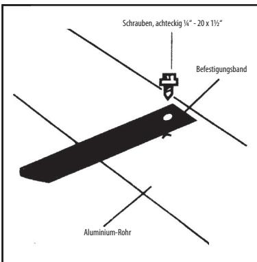
Bohren Sie Löcher in die Aluminium-Rohre, passend für die Befestigung der Bänder der Iso-Noppenfolie
