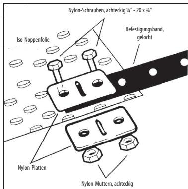
Bei der Befestigung der Gurte auf einen gleichmäßigen Abstand achten. Die Länge der Befestigungsbänder ist der Form des Pools anzupassen.
