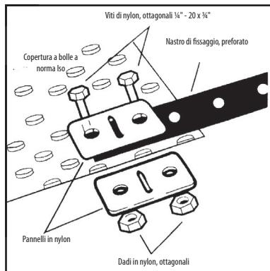
Al momento del fissaggio delle cinghie assicurare intervalli regolari tra di esse. La lunghezza del nastro di fissaggio deve essere adattata alla forma della piscina.
