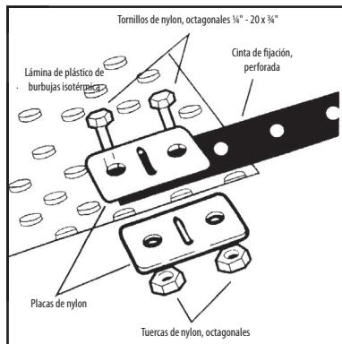
Cuando fije las correas debe prestar atención a mantener una distancia uniforme entre ellas. La longitud de las cintas de fijación debe ser adaptada a la forma de la piscina.
